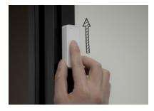
2. 将门磁探测器向上推,可以将其从框架上移除。
